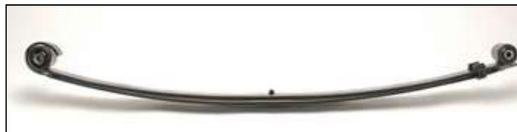
**Resortes:** Se utilizan en las suspensiones principalmente de automóviles y en la parte delantera de camiones ligeros. Son de menor peso que las muelles, de tal manera que el peso del vehículo que los utiliza decrece, aumentando el rendimiento del combustible del mismo. Los resortes tienen la función de amortiguar y dar confort en el manejo.
